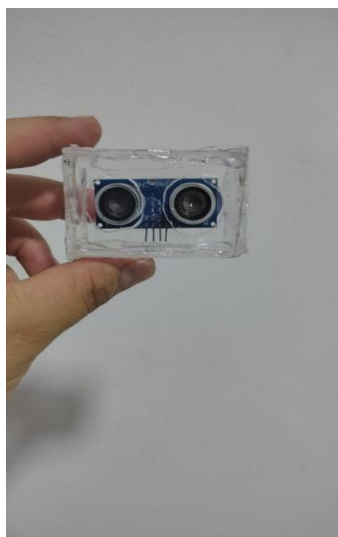
Protección en Acrílico del Sensor Ultrasónico
