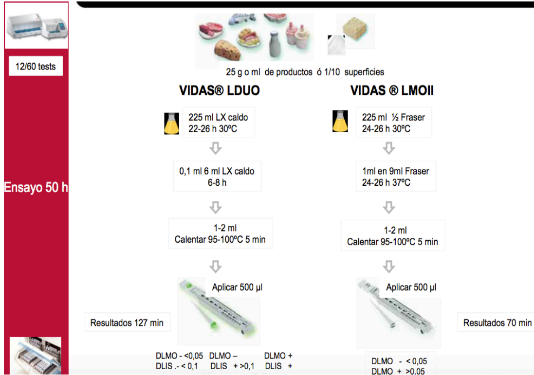
Figura 14. Técnica de VIDAS/miniVIDAS Listeria monocytogenes . Esta metodología es de gran utilidad ya que reduce los tiempos del ensayo a sólo 50 horas. Fuente: (Aymerich, 2010)
