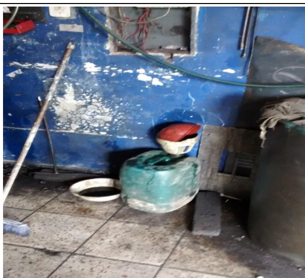
Recipientes de recibo primario y tanque de almacenamiento temporal ubicados cerca de cables eléctricos
