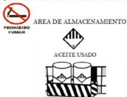
Figura 5. Letreros de señalización del área de almacenamiento
