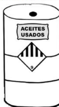
Figura 6. Rotulación de tambor de almacenamiento
