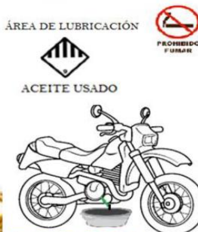
Figura 7. Identificación y señalización de área de trabajo – cambio de aceite.
