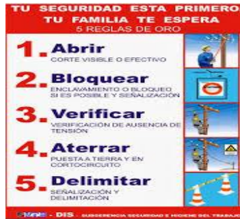
Fig.11 (5 reglas de oro eléctricas)
