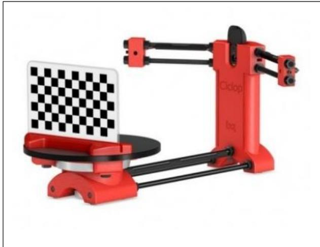
Figura 11. Escáner 3D.
