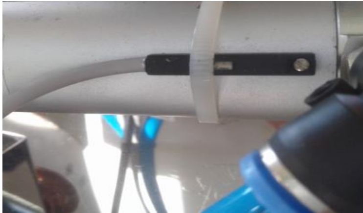
Fotografía 5. Sensor Magnético D-Z73.
