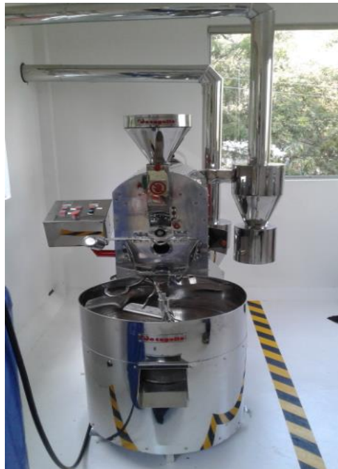
Fotografía 1. Tostadora JotaGallo sin automatización.
