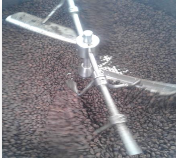
Fotografía 17. Tamiz de enfriamiento.
