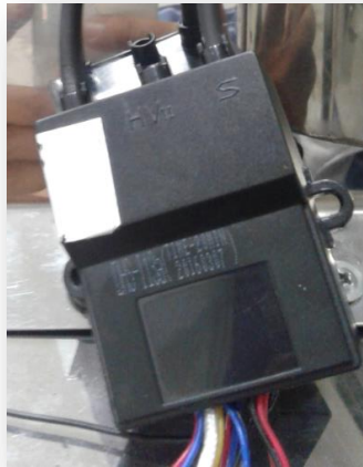
Fotografía 12. Controlador de combustión.
