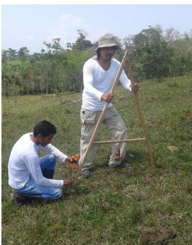
**Figura 2.** Determinación de pendiente con agronivel.
