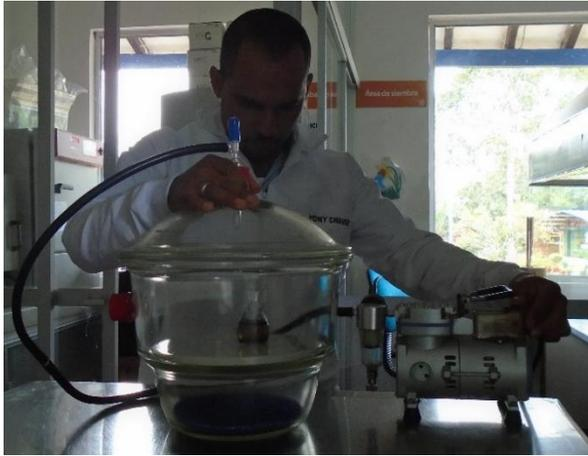
**Figuras 8 y 9.** Procesamiento de muestra para densidad real.
