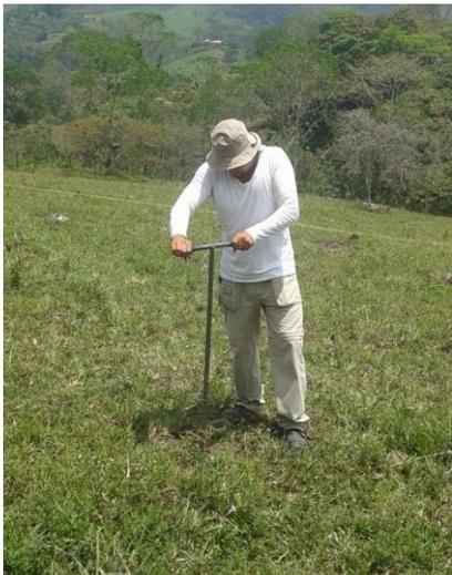
**Figura 11.** Toma de muestras con barreno.
