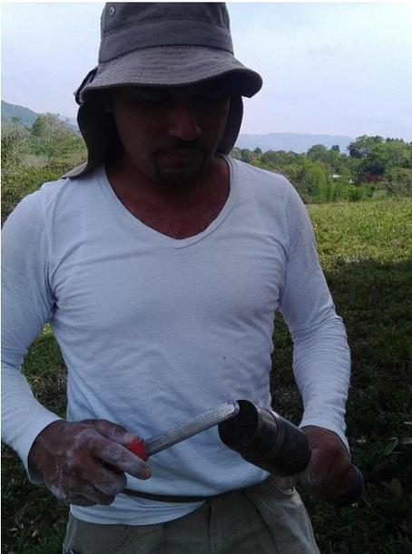
**Figura 6.** Toma de muestras para densidad aparente.
