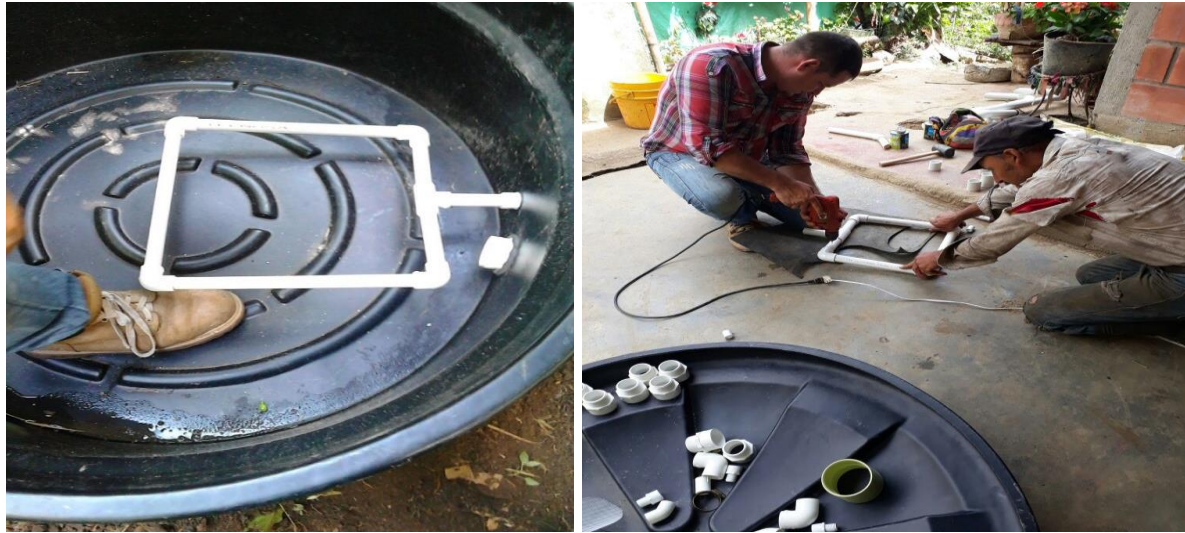
Fig.16.17. Apertura diámetro caneca en PVC Fuente: El Autor
