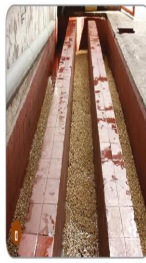
Fig.10. Canal de correteo y agitación manual Autor: Cenicafé
