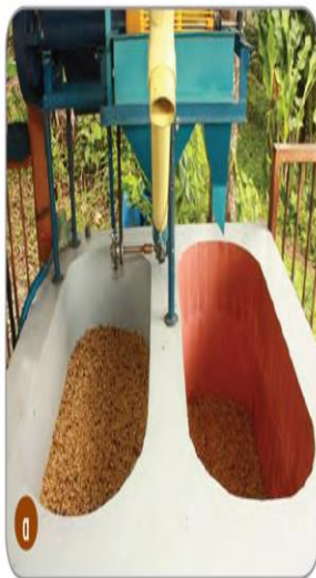
Fig.9. Tanque tina y paleta para el lavado Autor: Cenicafé
