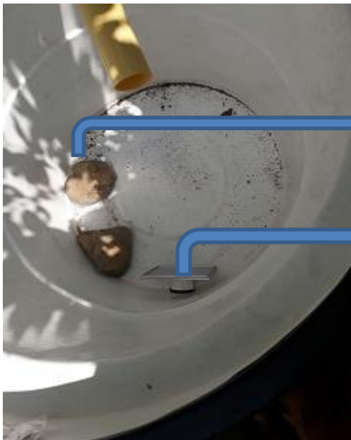
Fig. 21. caneca vacía en proceso de llenado de Material filtrante piedra, gravilla y carbón activado Fuente: El Autor
