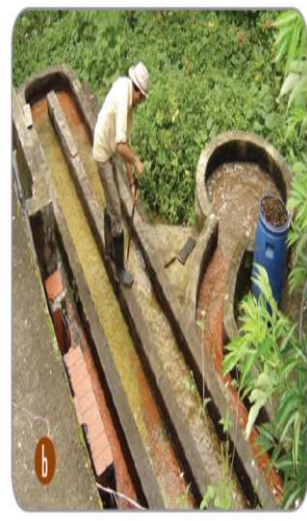
Fig.10. Canal de correteo y agitación manual Autor: Cenicafé
