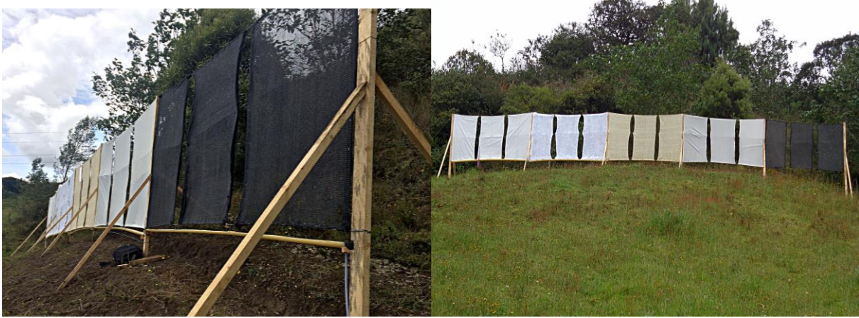
Figura 23. Sistema experimental de atrapanieblas con cinco tratamientos
