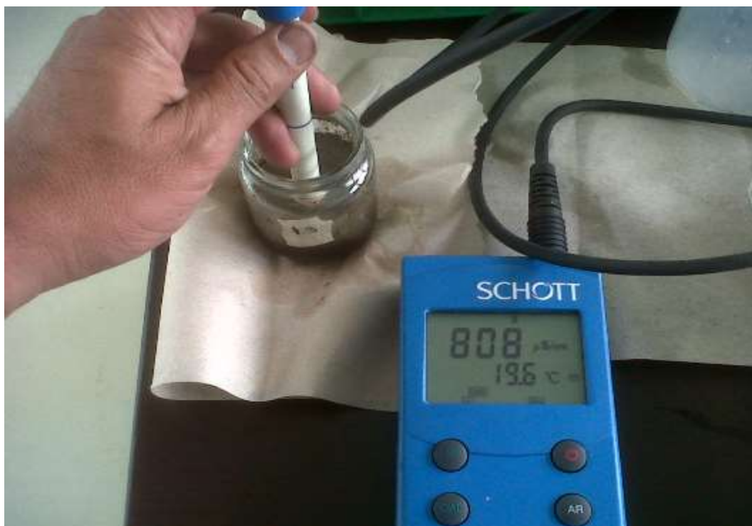
Figura No. 17: Medición de pH del suelo. Foto: F. Sanabria (2015)
