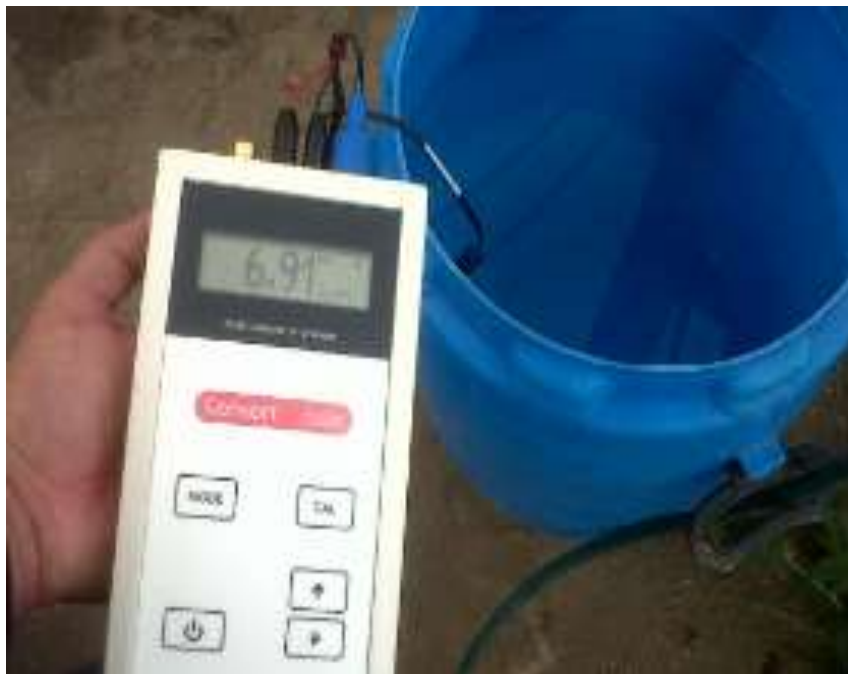
Figura No. 7: Medición pH agua potable. Foto: F. Sanabria (2015).
