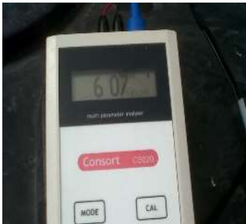
Figura No. 9: Medición pH agua tratamiento acidificado. Foto: F. Sanabria (2015).
