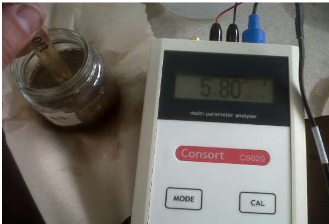
Figura No. 17: Medición de pH del suelo. Foto: F. Sanabria (2015)
