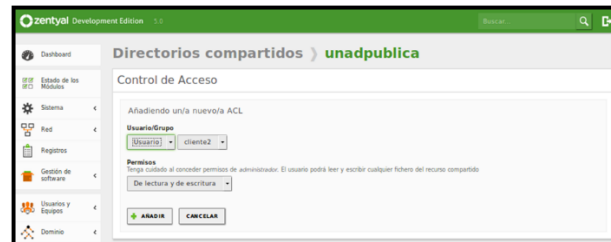
Imagen 57. Parametrización de permisos sobre carpeta
