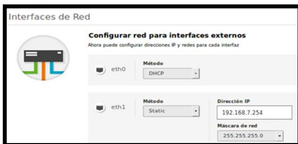
Imagen 39. Eth0 con DHCP y eth1 con IP estática.
