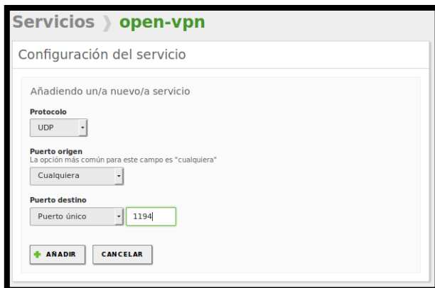
Imagen 66. Configuración del servicio – Puerto 1194.
