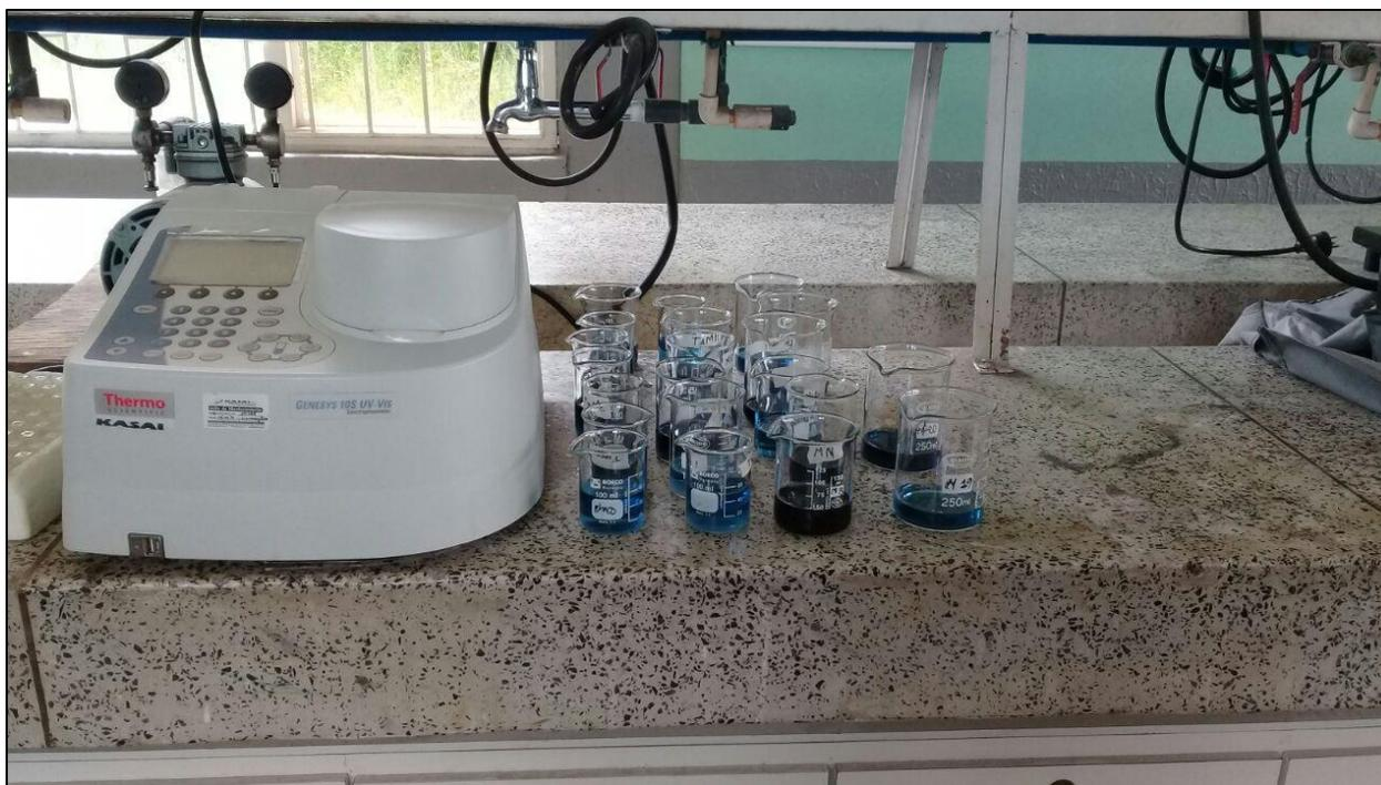
Fotografía 10. Determinación espectrofotométrica de Nitratos en aguas.
