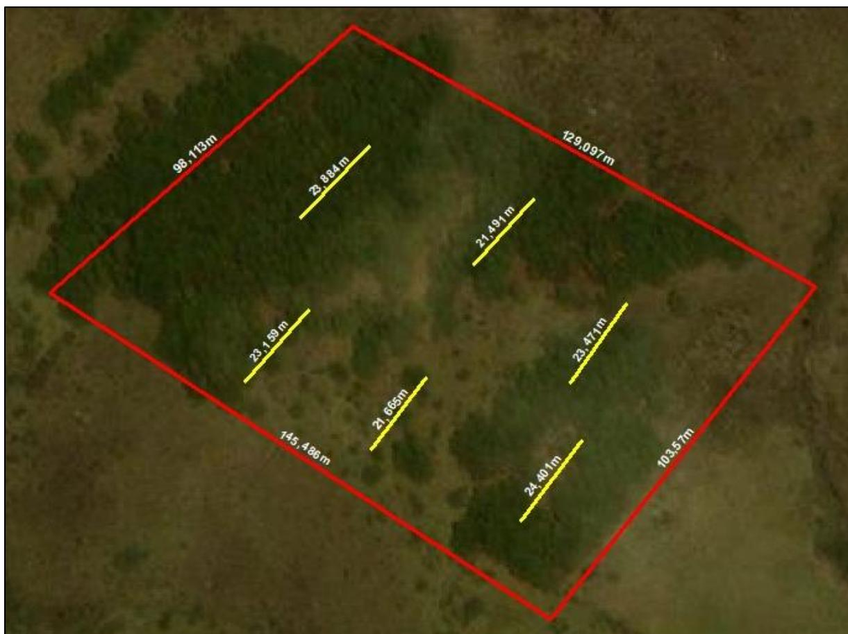
La imagen corresponde al punto de muestreo de flora en la vereda Chaguata, se observa el área donde se realizó el muestreo y los transectos lineales que se trazaron sistemáticamente con distancias de 20 a 25 metros.
