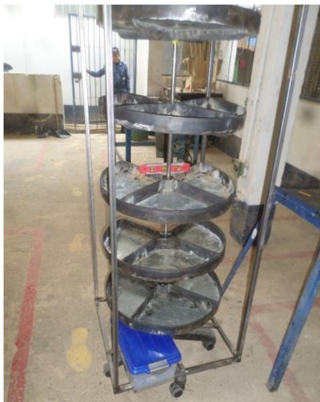
Fotografías 4, 5 y 6: se evidencia las cinco bandejas y la instalación en el eje central.
