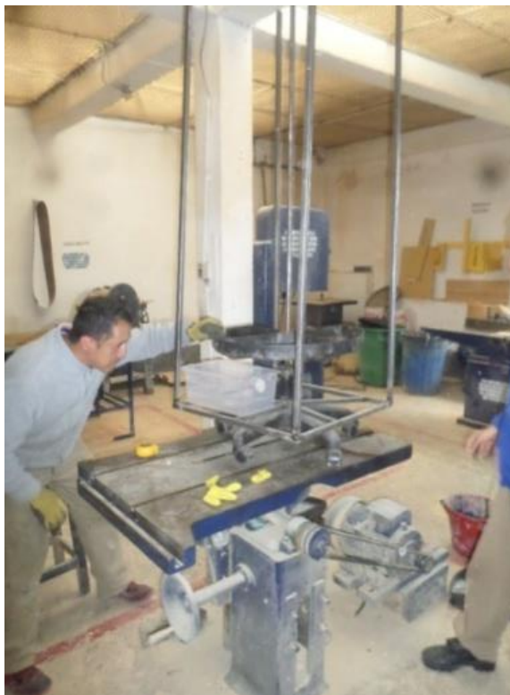
Fotografías 1, 2 y 3: se evidencia la construcción de la parcela didáctica. Hechura de bandejas, instalación de eje central al soporte rodante y hechura del marco en tubo cuadrado para dar estabilidad a la parcela didáctica.
