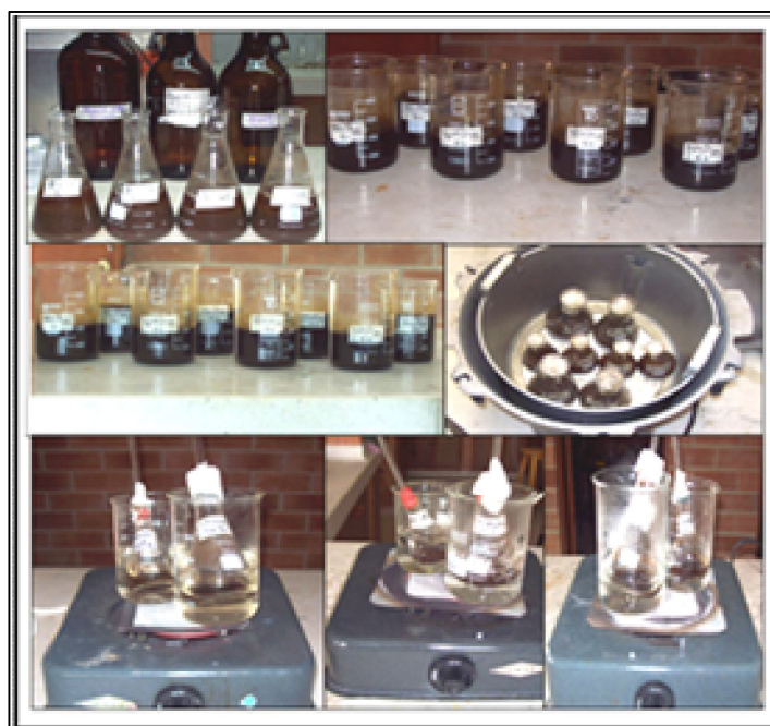
Figura 14. Procedimiento hidrólisis química de la celulosa y almidón de las cáscaras de naranja y papa.
