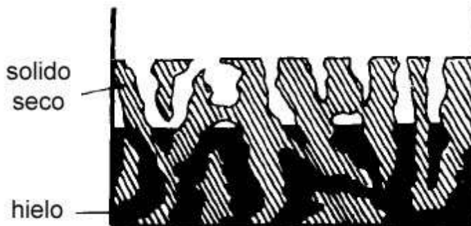
Figura 10. Estructura de un producto en proceso de liofilización
