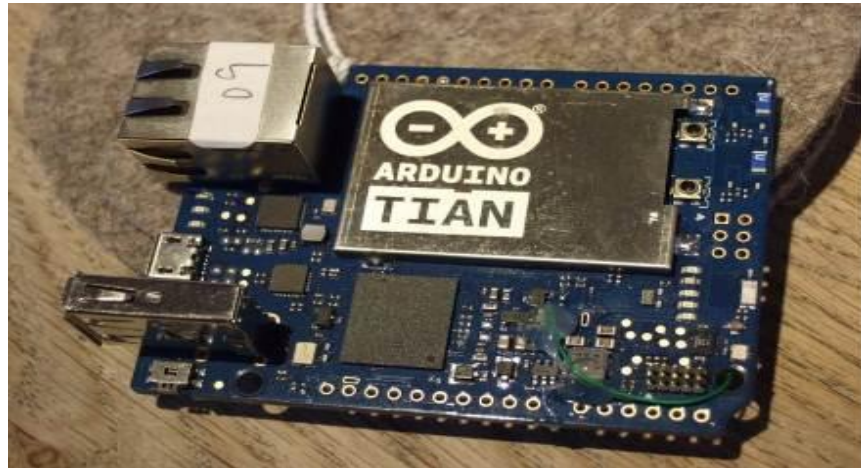
Figura 6. Placa de circuito compacta Arduino Tian
