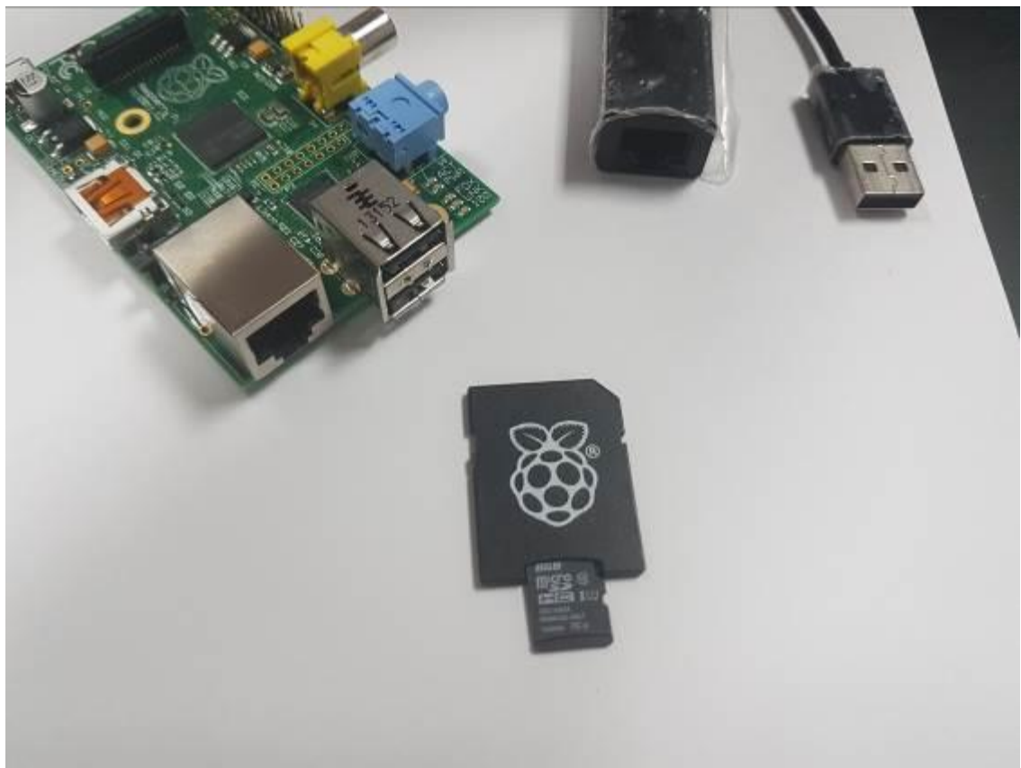
Figura 13. Raspberry Pi1 y componentes del Appliance
