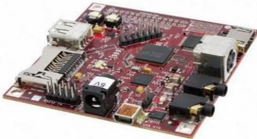
Figura 5. Placa de circuito compacta BeagleBoard
