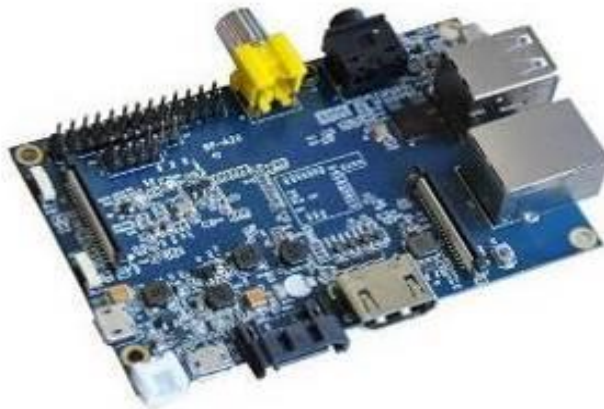
Figura 4. Placa de circuito compacta Banana Pi
