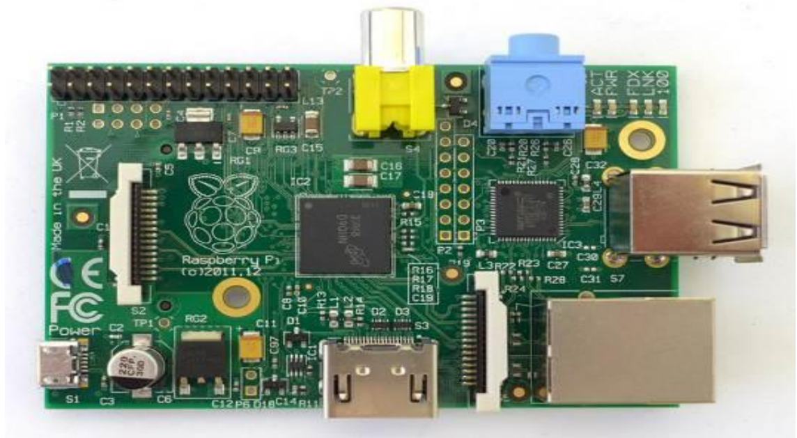
Figura 8. Placa de circuito compacta Raspberry Pi1 B
