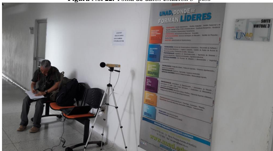
Figura No. 22. Toma de datos estación 3° piso
