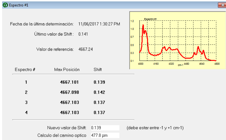
Figura 17. Prueba de repetibilidad del espectrómetro NIR con n-hexano
