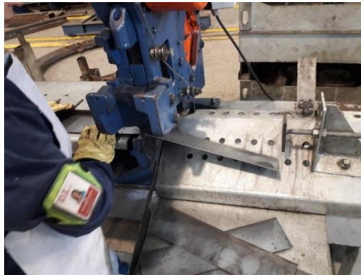
Figura 18: (2018). Operario cortando placas en la cizalla universal Dimel Ingeniería. [image]
