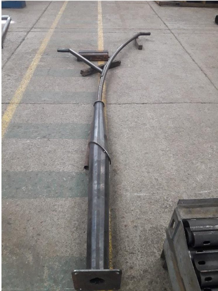
Figura 22: (2018). Poste de iluminación tipo vasto fabricado por Dimel Ingeniería. [image]
