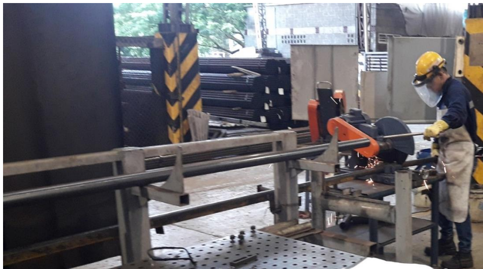
Figura 9: (2018). Operario cortando tubería en maquina tronzadora Dimel Ingeniería. [image]
