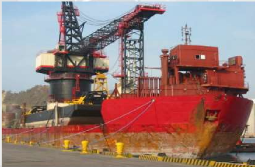
Barcaza sumergible con grúa flotante a bordo
