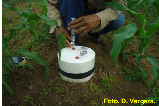
Figura 15. Forma de instalar la cámara.
