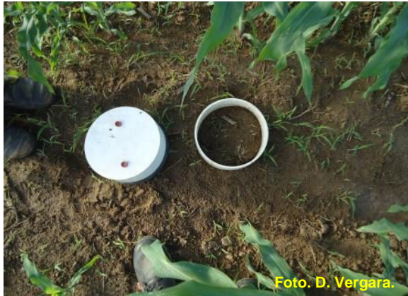
Figura 14. Anillo y cámara de PVC.
