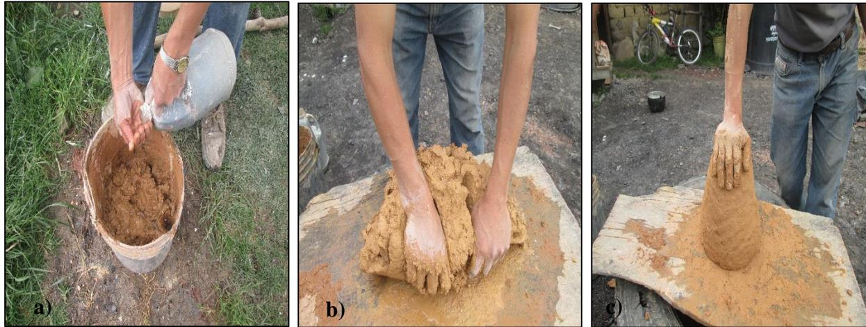
**Foto 3.** Preparación de la mezcla (Arcilla, aserrín y agua).
