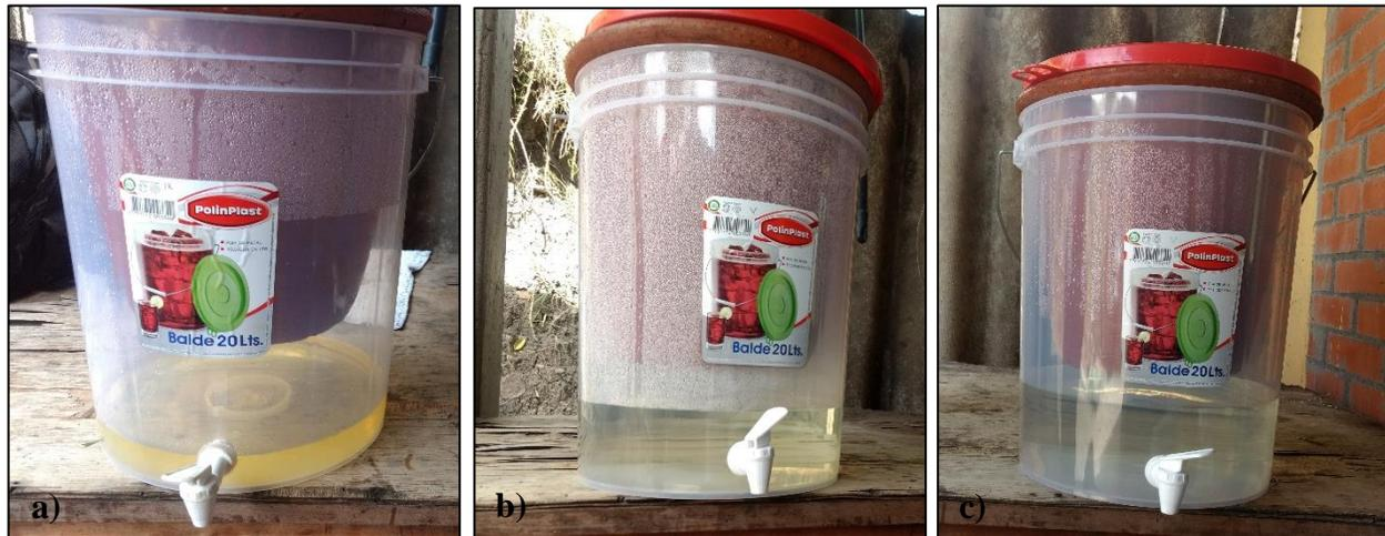
**Foto 13.** Liberación plata coloidal no absorbida por el filtro.
