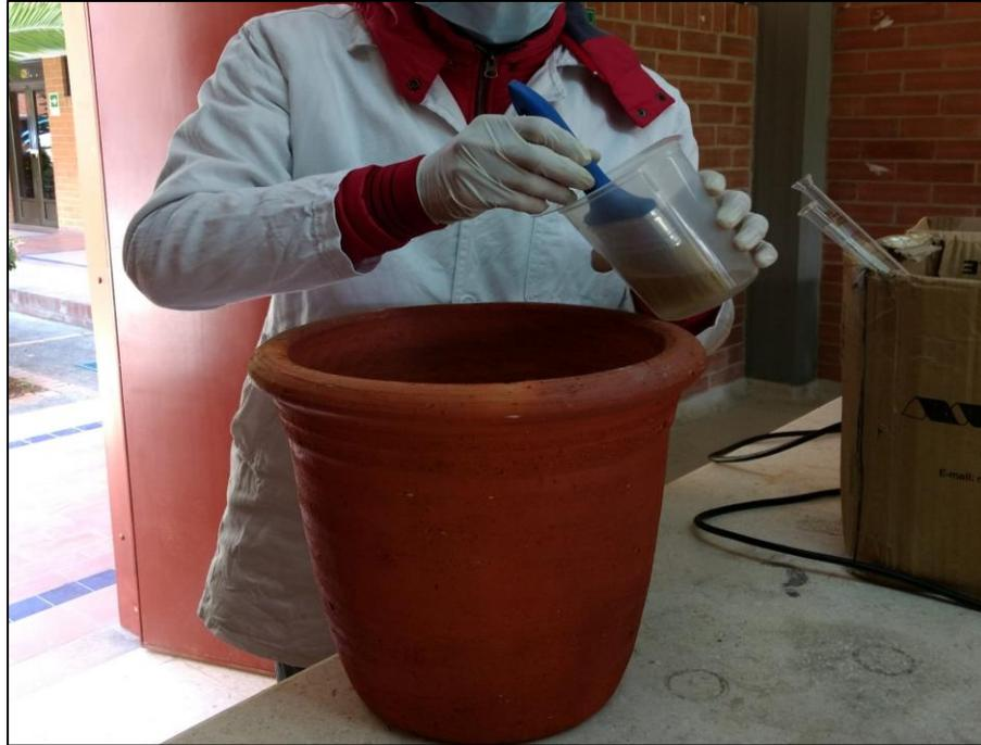
**Foto 12.** Aplicación de plata coloidal al filtro en cerámica.
