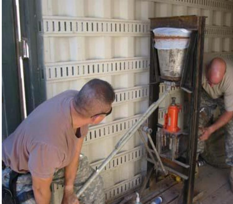
**Figura 2.** Moldeado mecánico del filtro con prensa hidráulica.
