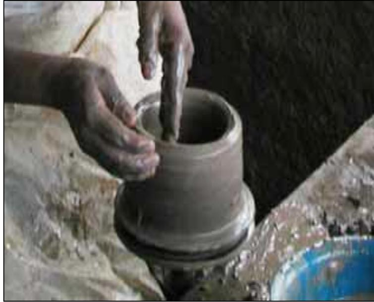
**Figura 1.** Moldeado y torneado manual de la cerámica.
