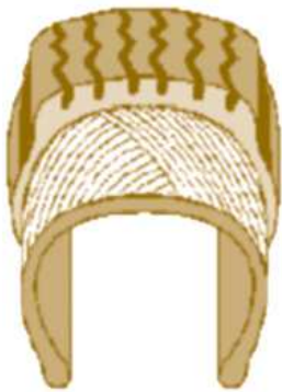
Imagen 3: Estructura llanta radial
