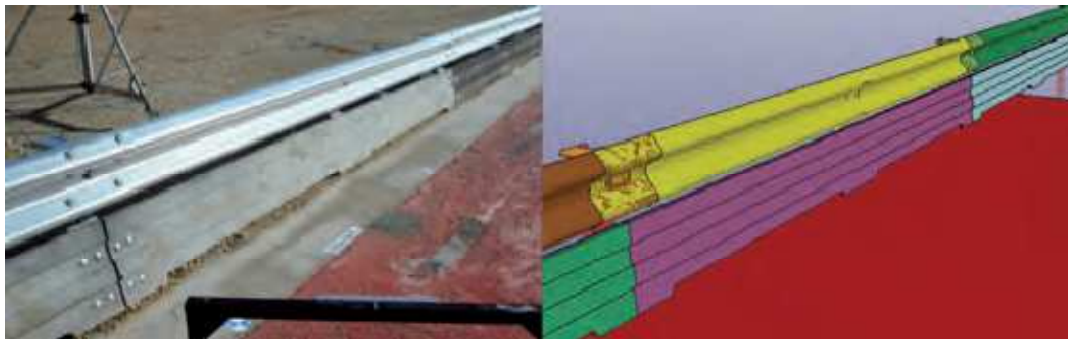
Imagen 6 : Vista en perspectiva del prototipo original de SPM (izquierda) y de su modelo en LS-DYNA (derecha)
