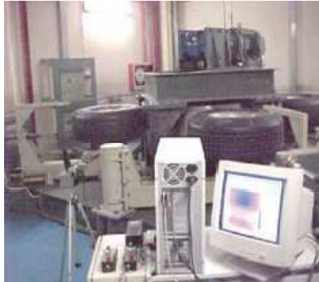
Imagen 12: Montaje del dispositivo de Captación termográfica en el banco de ensayos de neumáticos
