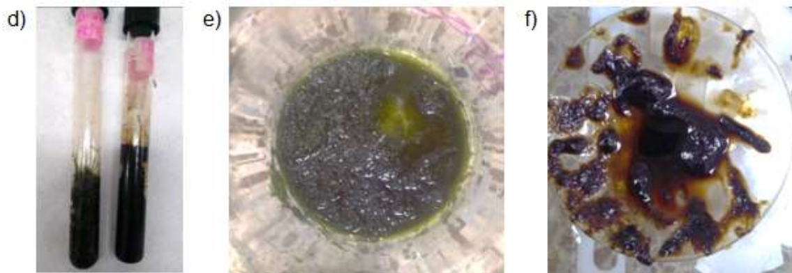
Figura 30. d) Proceso de tratamiento con líquido iónico [BMIM][Cl] en interacción con la biomasa, e) Muestra de pasto No solvatado, f) Muestra de pasto solvatado con [BMIM][Cl]
