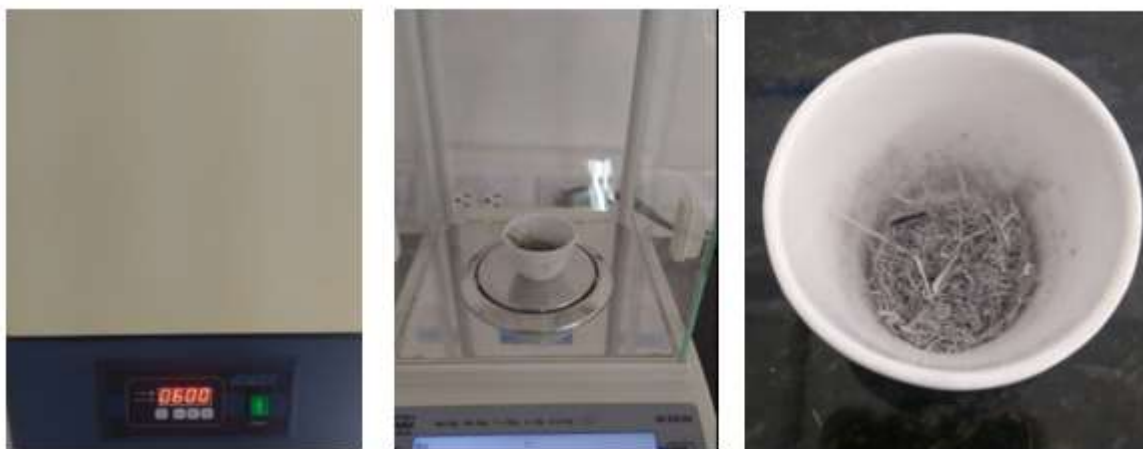
Figura 18. Proceso de determinación de ceniza a) Mufla programada, b) Pesaje de muestra c) muestra análisis de ceniza
