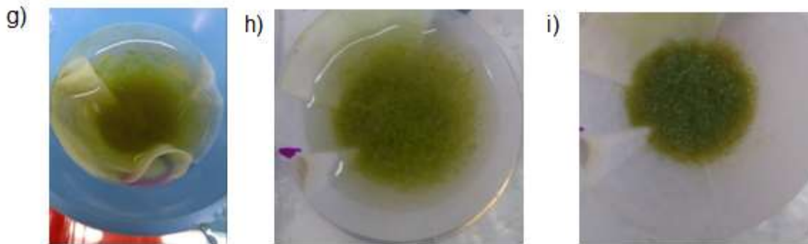
Figura 26. g) Filtración adición agua destilada, h) Filtración adición Ácido acético, i) Filtración adición agua destilada
