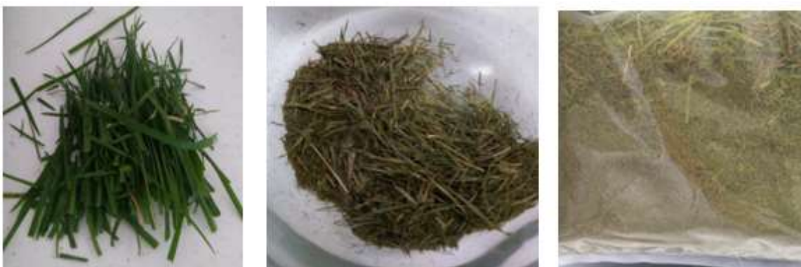
Figura 16. Proceso de secado de residuo de pasto común a) Muestra de pasto cortado antes de secado b) muestra después de secado c) muestra almacenada
