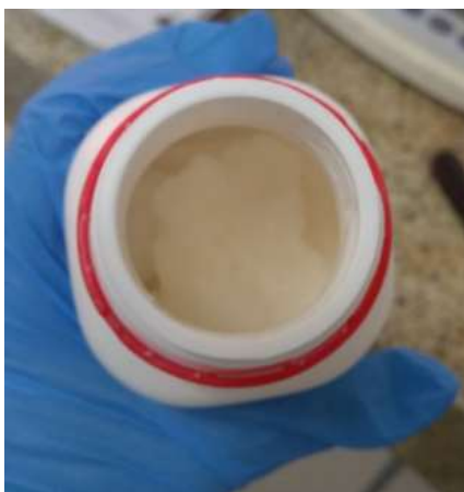
Figura 40. Estado sólido del [BMIM][Cl] a temperatura ambiente
