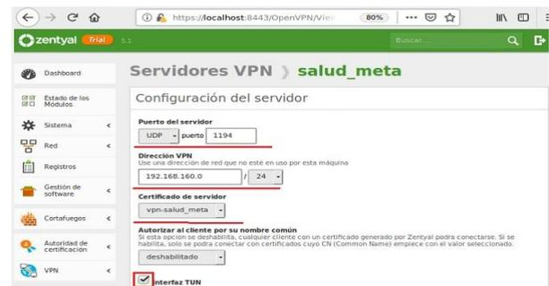
Imagen 86. Configuración servidor VPN Zentyal.
