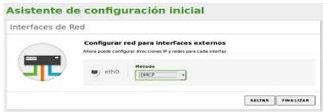
Imagen 82. Configuración tarjeta de red Zentyal
