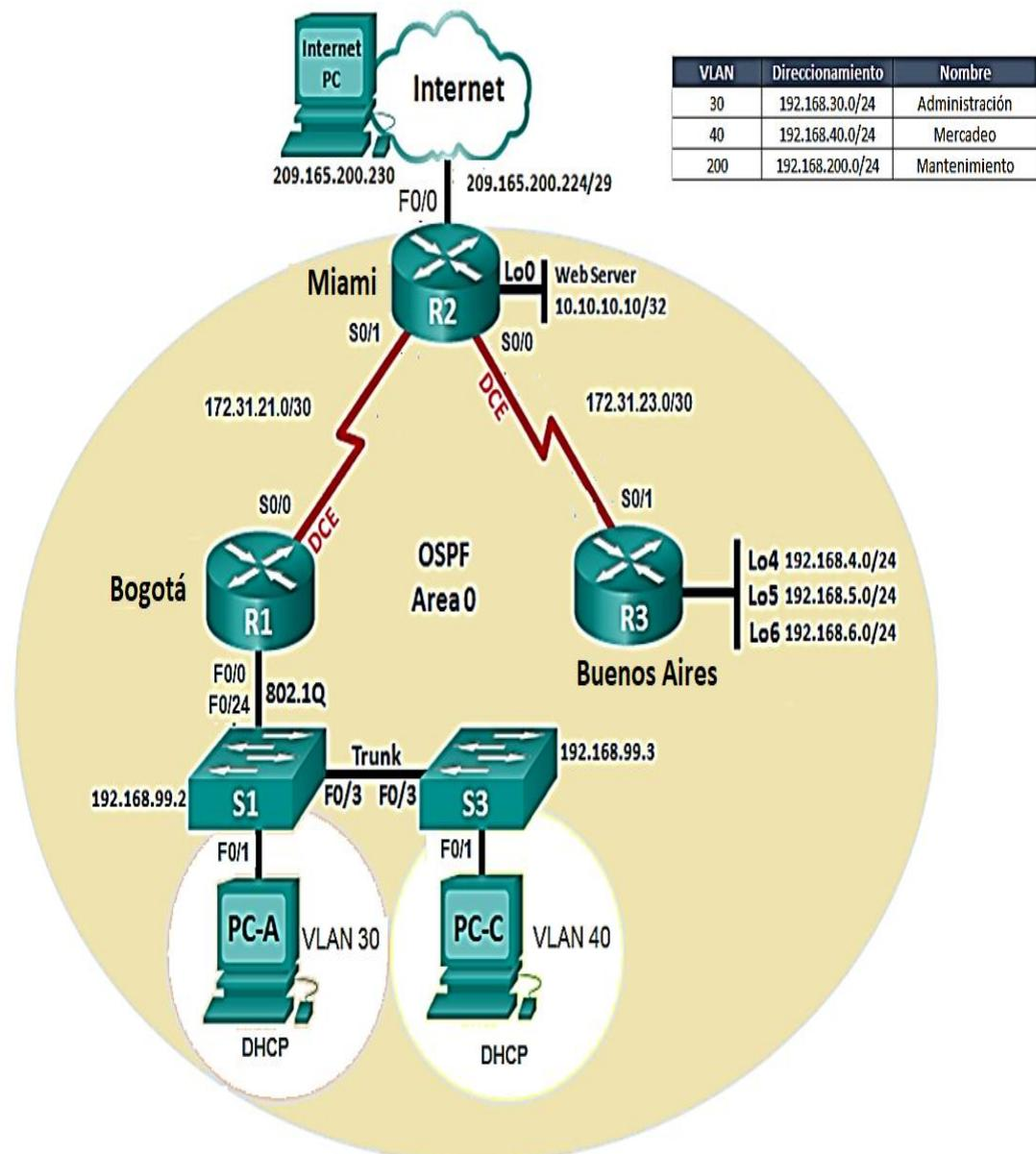
**2.1. Configurar el direccionamiento IP acorde con la topología de red para cada uno de los dispositivos que forman parte del escenario**
