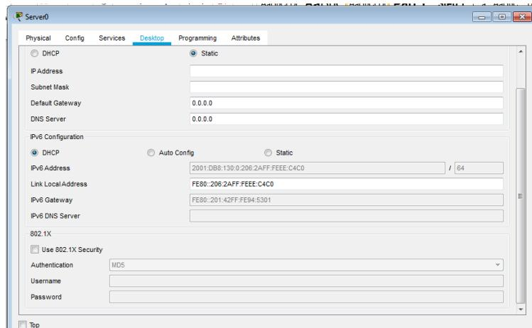
**1.9 La NIC instalado en direcciones IPv4 e IPv6 de Laptop30, de Laptop31, de PC30 y obligación de configurados PC31 simultáneas (dual-stack). Las direcciones se deben configurar mediante DHCP y DHCPv6.**
