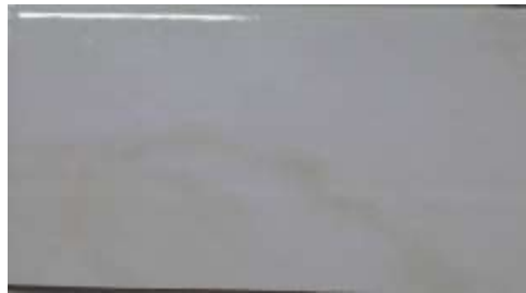
Imagen 28. Defecto por raya de campana
