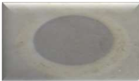
Imagen 26. Defecto por velo roto
