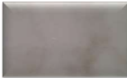
Imagen 22. Defecto por incrustación de engobe
