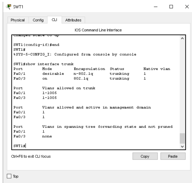
Ilustración 16. Resultado aplicar comando show interface trunk switch SWT1
