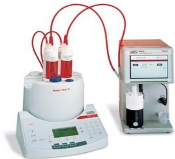
Figura 3. Equipo para medir las demandas de carga de las aguas de la máquina de papel en menor tiempo
