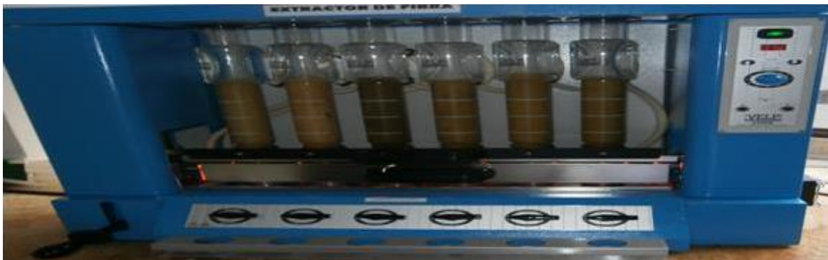
Figura N° 4. . Procedimiento fibra detergente neutra (FDN).
