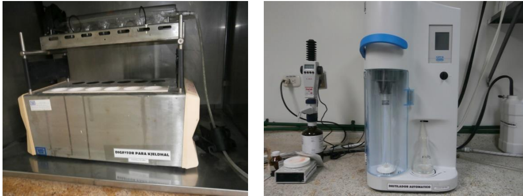
Figura N° 5. Equipos para el procedimiento para proteína.
