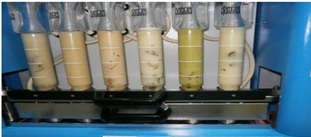
Figura N° 3. Procedimiento fibra detergente acida (FDA).
