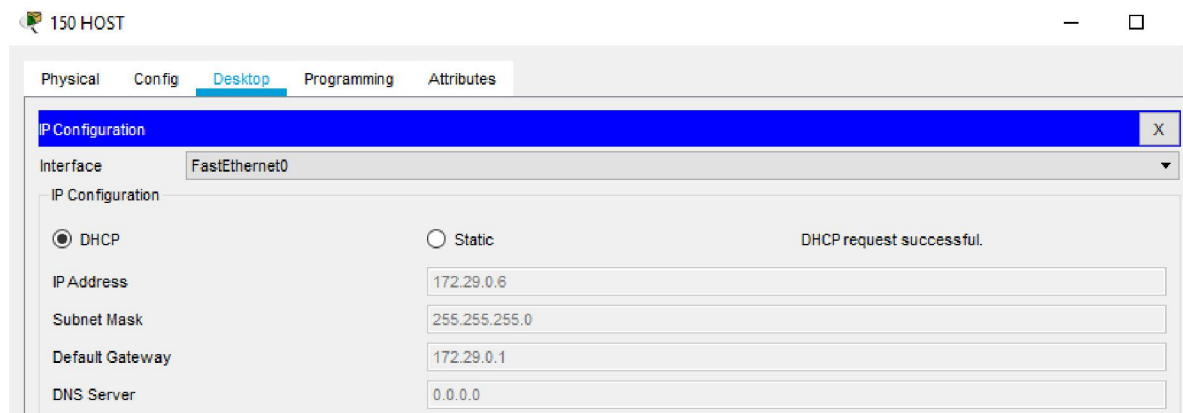
Figura 77. Dirección IP recibida por el ordenador de referencia para los 150 host mediante el servicio DHCP
