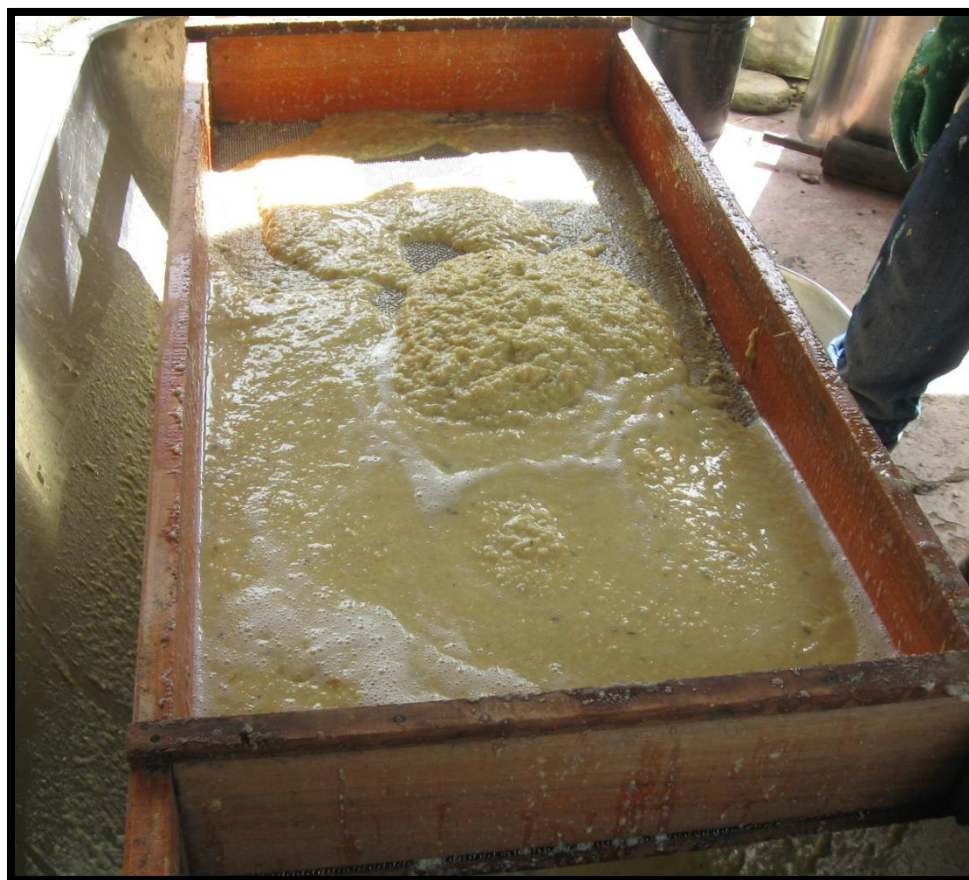
Foto 14. Zaranda de madera para despulpado de chamba (Méndez).
