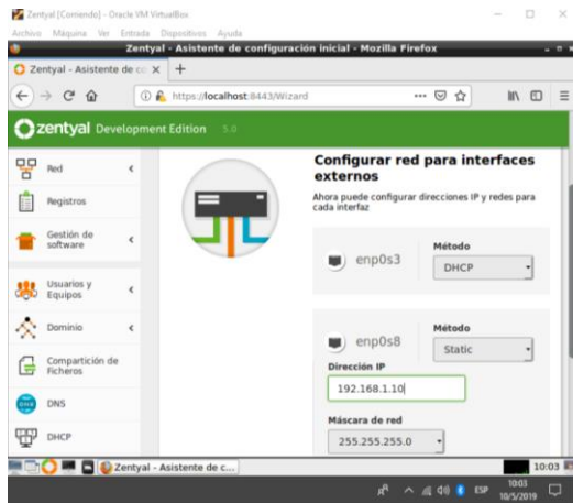
Fig. 16 Configuración de red interna.
