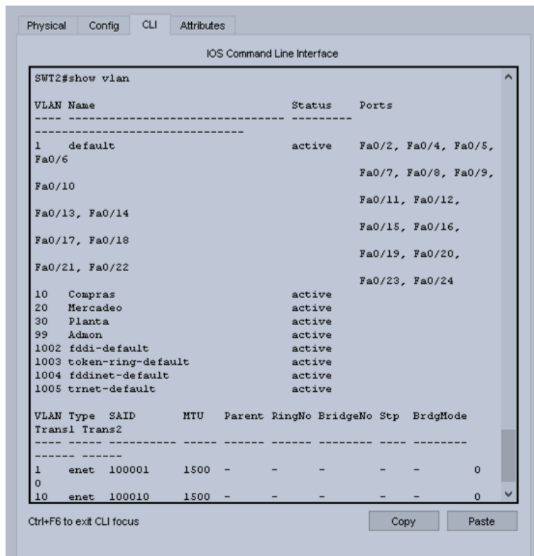
Figura 17. Verificación de la creación de VLANS en SWT2
