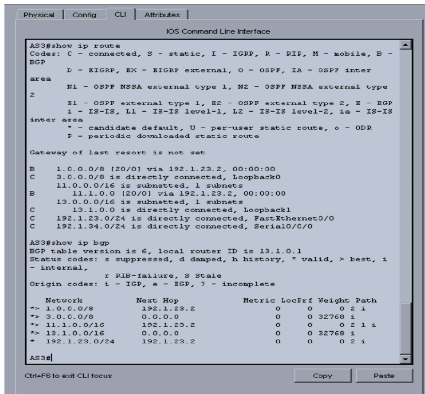
Figura 8. Presentación paso con los comandos utilizados y la salida del comando show ip route 3
