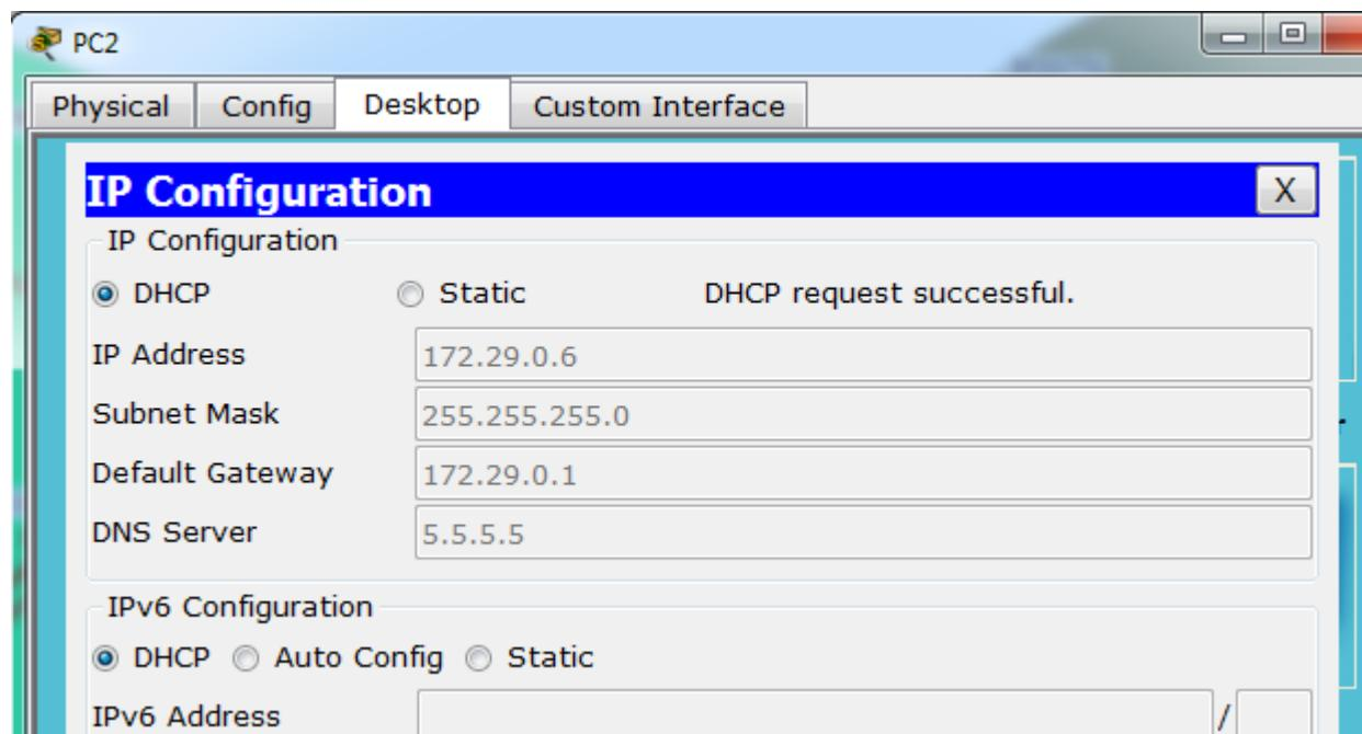
Configuramos el DHCP, como el router BOGOTA tiene una red LAN conectada pero no realizara las veces de servidor DHCP, es necesario configurar “ip helper” el cual permitirá ser un router des tránsito para llegar al router con el roll de DHCP. Por lo anterior utilizamos el comando ip helper- address para atrapar los broadcasts y redireccionarlos hacia la ip del router de BOGOTA2:
