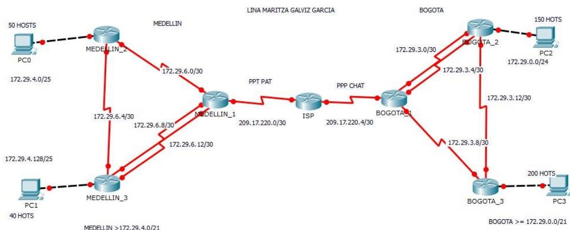
**Descripción:** Se desarrolló diseño en Packet tracer con los equipos descritos en el escenario 1, estos quedan listos para su configuración, se realiza el cableado para la conexión de cada uno de los dispositivos de red, se agregaron módulos con puerto serial adicional para realizar la configuración en ciertos router que necesitan más de dos conexiones por cable serial.
