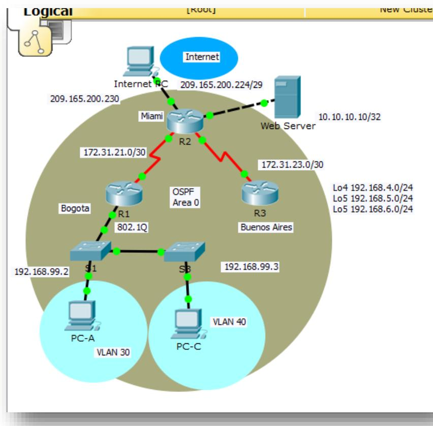
**Direccionamiento internet PC:** Ingresamos a la interface de configuración del dispositivo en la pestaña desktop y en la opción IP configuración static, digitamos la IP address, la máscara de subred y el default wateway.
