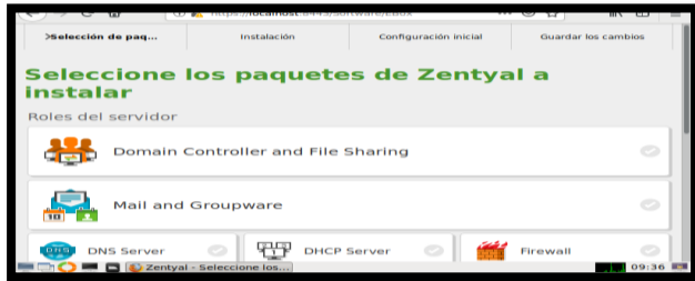
Figura 48. Instalación De paquetes de zentyal para VPN Para la implementación de la VPN se requiere del módulo de red, firewall, autoridad certificadora y VPN.
