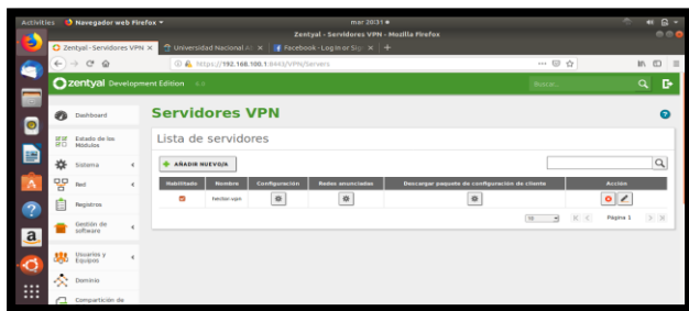
Figura. 89 Descarga de certificados para el cliente VPN Se deja la IP para conectarme al servidor VPN 192.168.1.2 que es la IP del servidor zentyal.
