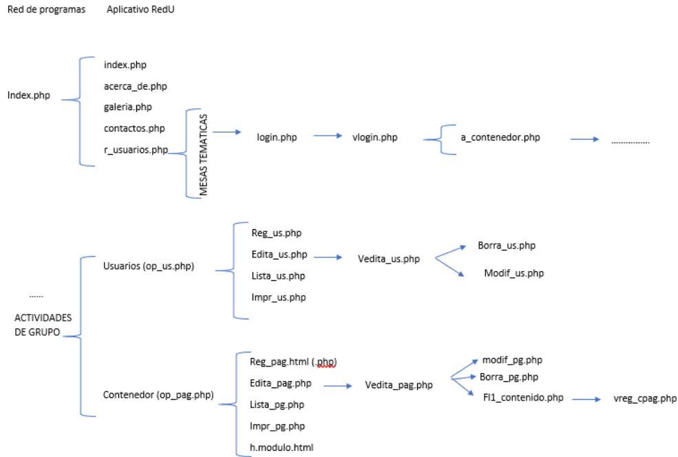
Ilustración 31 Diagrama de componentes del sistema
