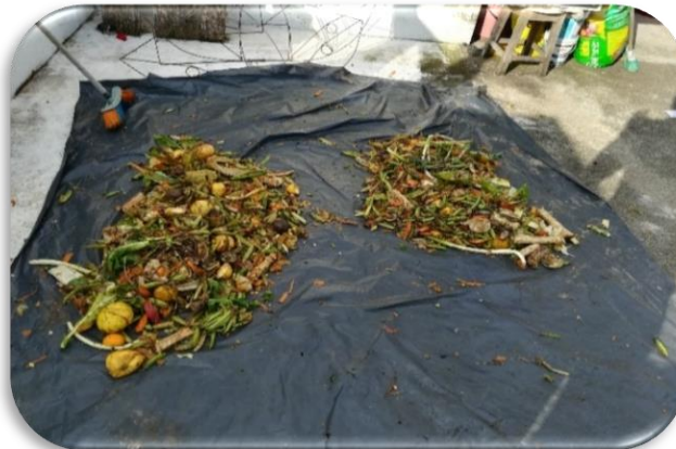
Figura 12. Reducción de la muestra.
