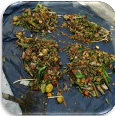
Figura 11. Nuevo cuarteo de la muestra.
