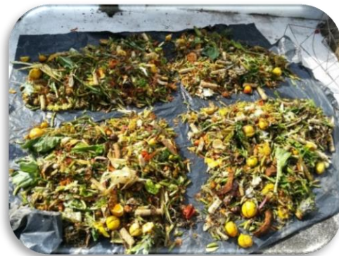
Figura 9. Primer cuarteo de la muestra
