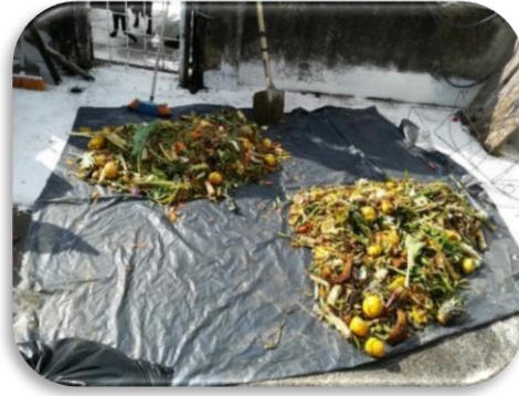
Figura 10. Extracción de dos cuartos de RSO.
