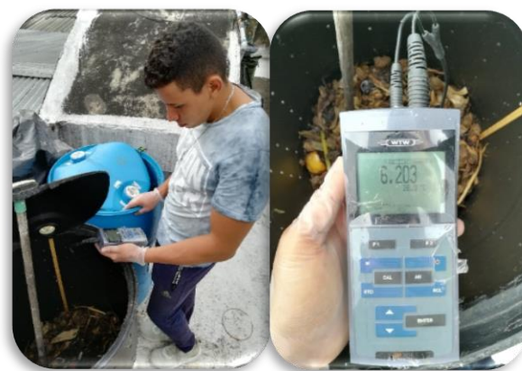
Figura 33. Toma de pH, Temperatura y aireación de los reactores.
