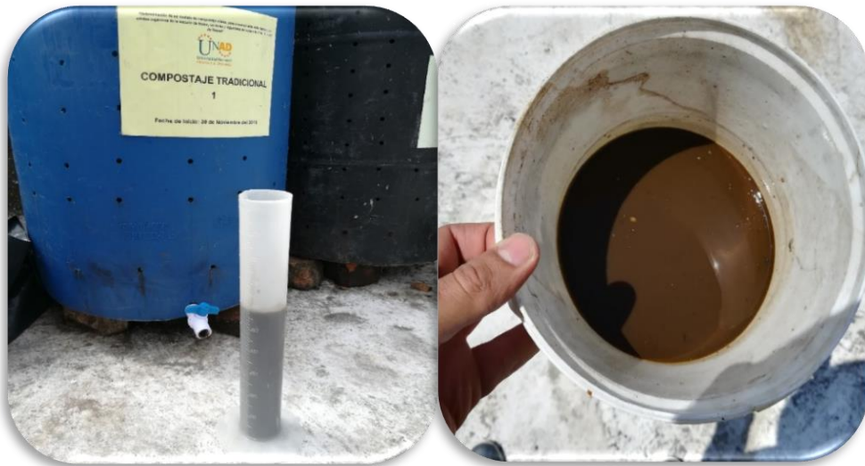
Figura 34. Recolección y medición de Lixiviados.
