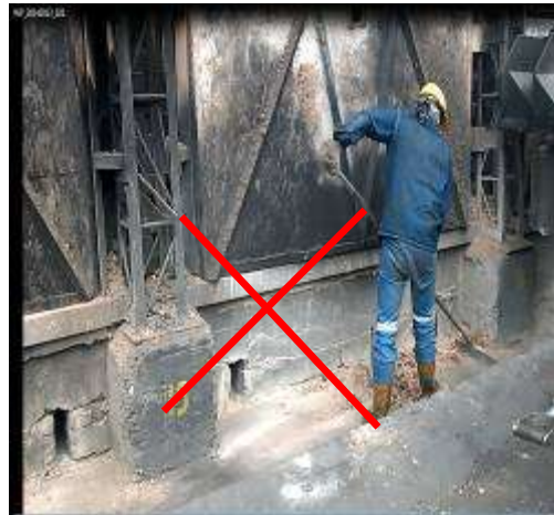
Figura N. 23 Postura incorrecta operación limpieza de residuos frente a la puerta de entrada
