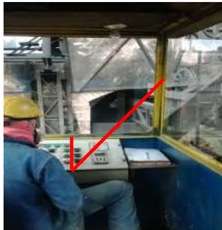
Figura N. 18 Postura correcta operación razado y apisonado de materia prima con pusher dentro del horno
