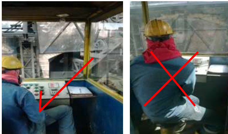
Figura N.12 Postura correcta e incorrecta operación de descargue a la vagoneta por medio de pusher
