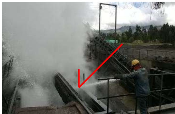
Figura N. 29 Postura correcta operación reapagado manual
