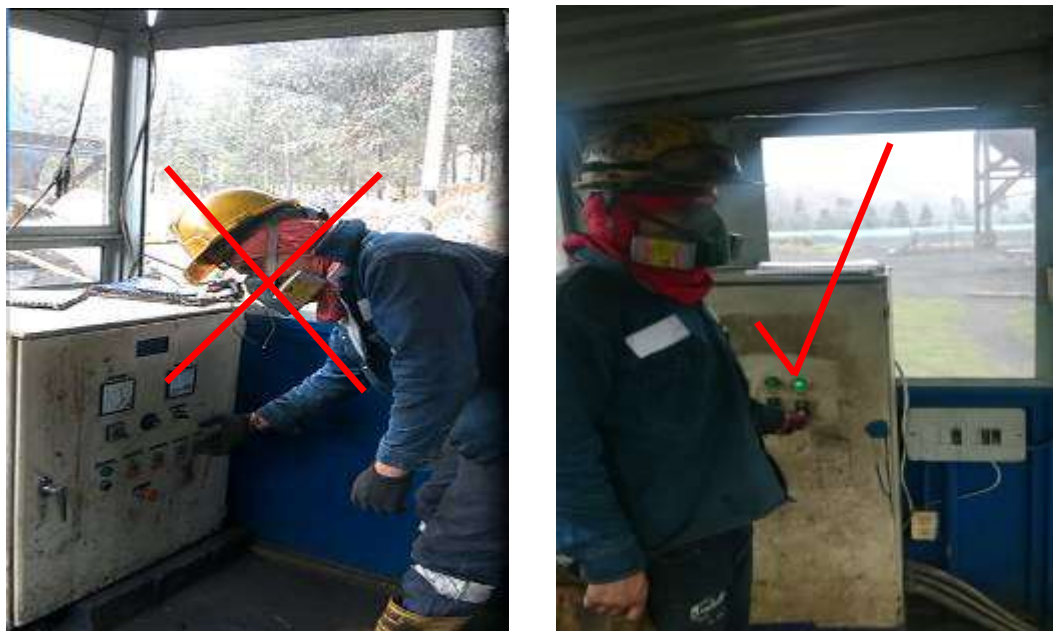
Figura N. 4 Posturas incorrecta y correcta operación de mandos en banda transportadora
