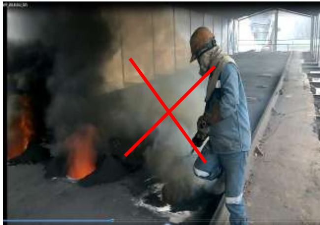
Figura N. 21 Postura incorrecta operación limpieza de la boca de cargue y tapado del horno
