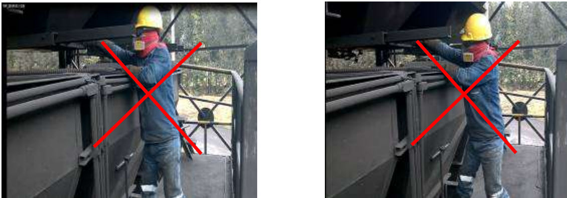
Figura N. 5 Postura incorrecta operación cargue de puente grúa
