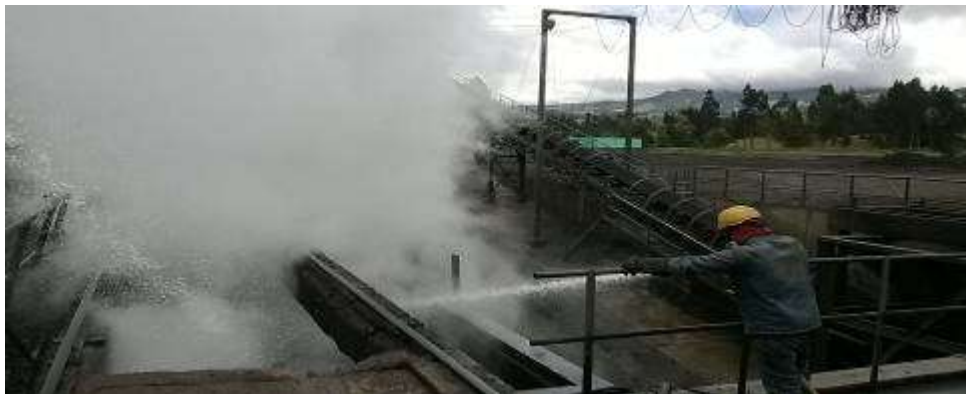
Figura N. 3 Proceso de reapagado. Fuente: C.I. Carbocoque S.A.
