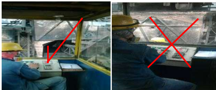
Figura N. 8 Postura correcta e incorrecta operación desplazamiento pusher
