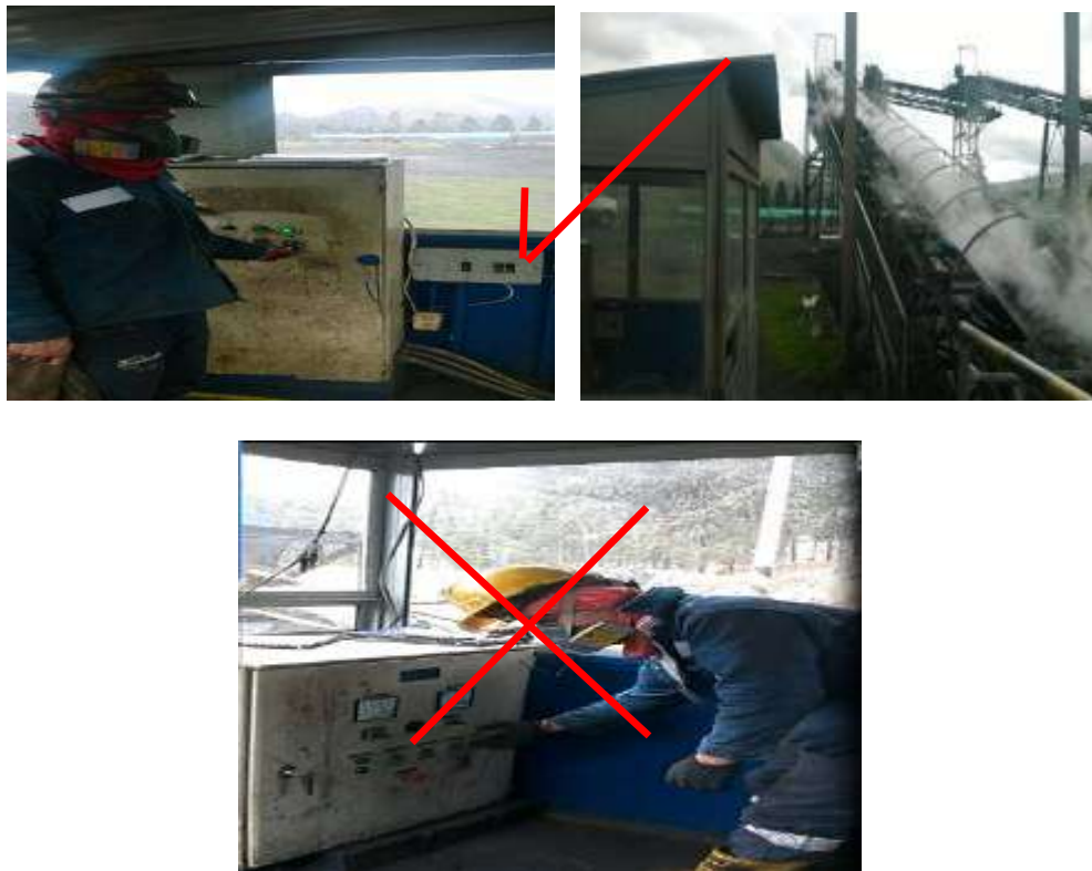
Figura N. 30 Postura correcta e incorrecta operación traslado del coque por banda transportadora a la tolva de cargue de vehículos.
