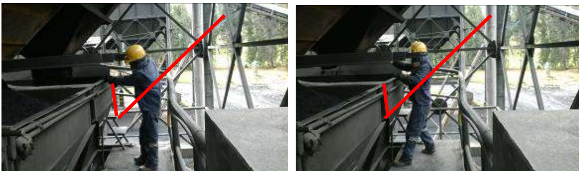
Figura N.6 Postura correcta operación cargue de puente grúa
