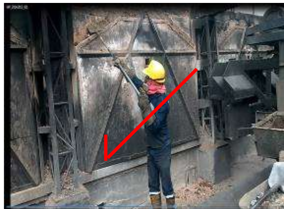
Figura N. 20 Postura correcta operación bajar puerta de entrada y sellado con arcilla
