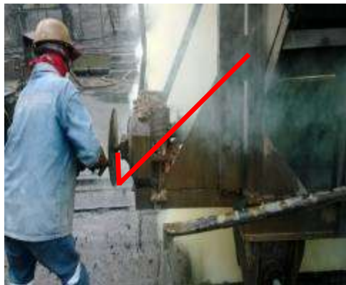
Figura N. 28 Postura correcta operación descargue de producto a tolva de reapagado
