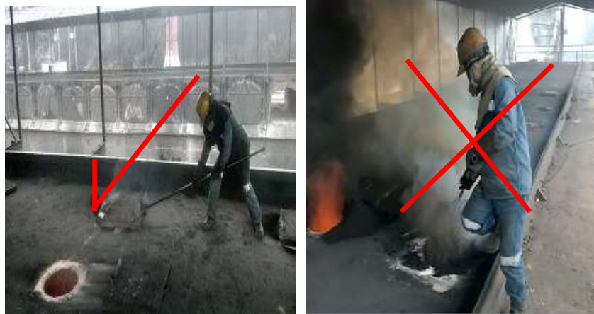
Figura N. 10 Postura correcta e incorrecta operación destape boca horno
