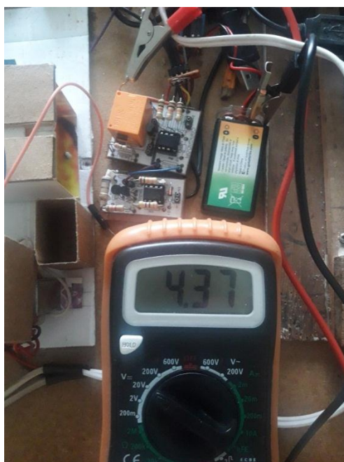
Figura 48. Medida en voltios del divisor de voltaje.
