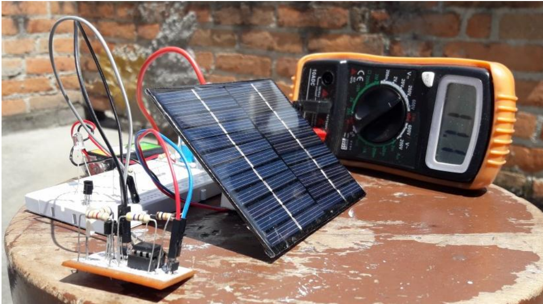
Figura 36. Medida en voltios del regulador de carga frente a un cielo totalmente despejado Fuente: Rodriguez, Manuel. (2019). Controlador de tele-asistencia para procesos domóticos. MAELEC 8.9. San Juan de Pasto, Colombia.
