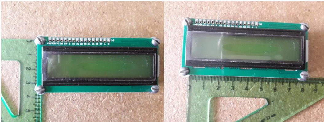
FIGURA 69. Medida en centímetros del módulo LCD
