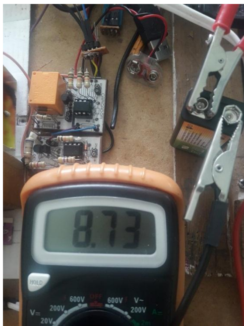
Figura 47. Medida en voltios de la batería.
