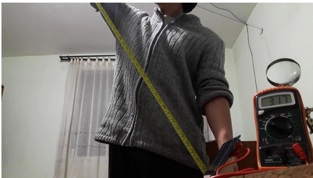
Figura 27. Midiendo distancia entre el panel solar y el bombillo, en el multímetro se muestra el valor en voltios que está generando el panel solar. Fuente: Rodriguez, Manuel. (2019). Controlador de tele-asistencia para procesos domóticos. MAELEC 8.9. San Juan de Pasto, Colombia.
