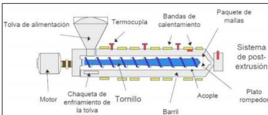
Figura 16. Esquema general de extrusora. Recuperado de *Plan de negocios para la puesta en marcha de una empresa productora de maderas plásticas en el área metropolitana de Bucaramanga* (p. 47), Oliveros, 2011.
