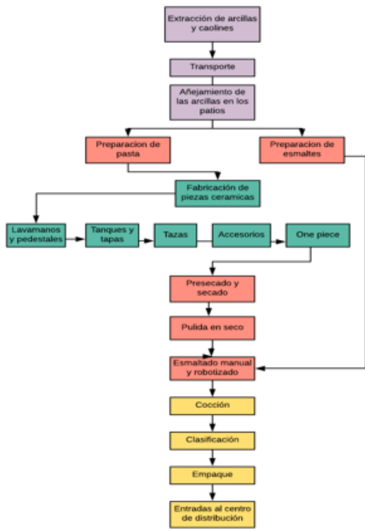
Figura 2. Diagrama de flujo de los procesos industriales de corona. Recuperado de:
