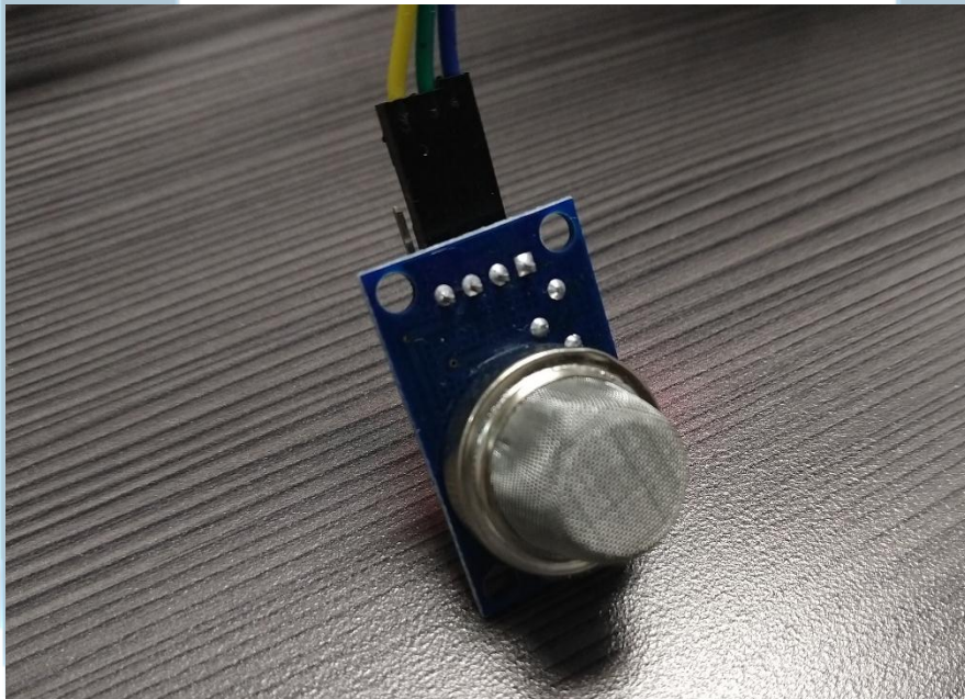
Figura 8. Sensor de humo y gases realmente utilizado en set y pruebas
