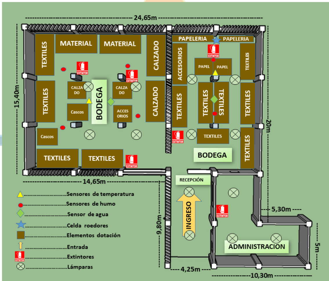
Figura 25. Ubicación de elementos electrónicos en el área de almacenamiento
