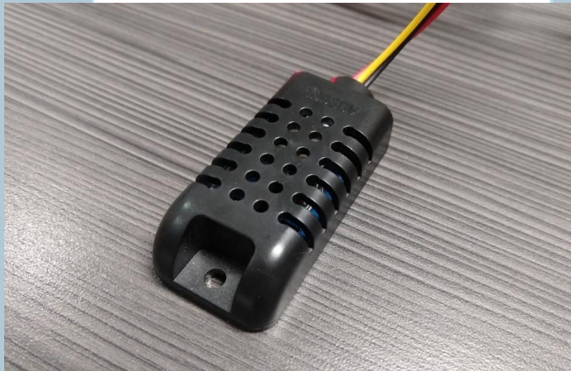
Figura 6. Sensor de temperatura y humedad realmente utilizado en el montaje y pruebas
