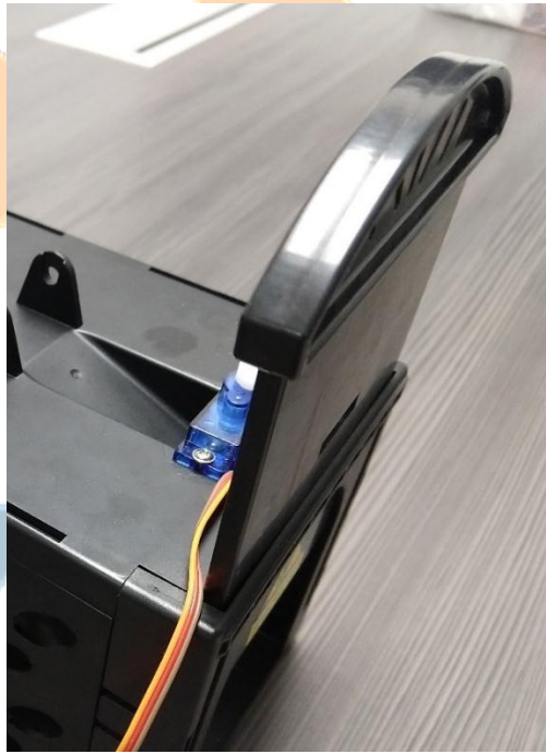
Figura 15. Servomotor en la trampa para roedores
