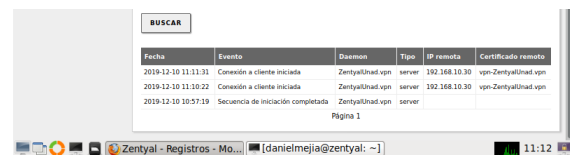
Imagen 68. Evidencia de conexión del cliente en Zentyal Server. Elaboración propia.
