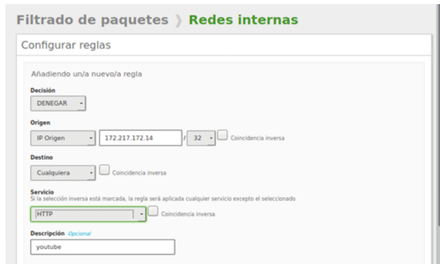
Imagen 48. Configuración de reglas en cortafuegos. Elaboración propia.
