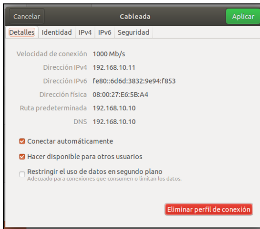
Imagen 22. Detalles configuración ip. Elaboración propia.
