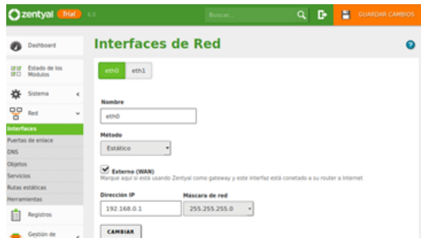
Imagen 45. Configuración tarjeta red0 en Zentyal. Elaboración propia.
