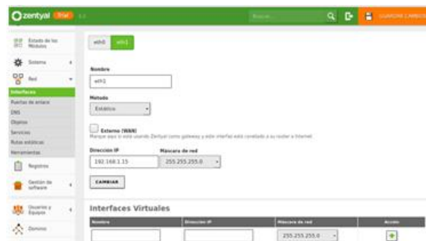
Imagen 46. Configuración tarjeta red0 en Zentyal. Elaboración propia.
