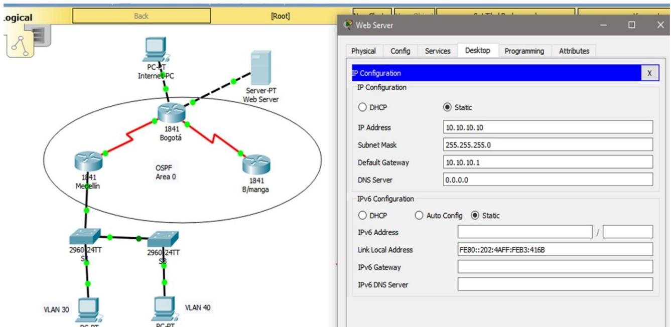
Configuración de seguridad Switch, VLANs, Inter-VLANs Routing
