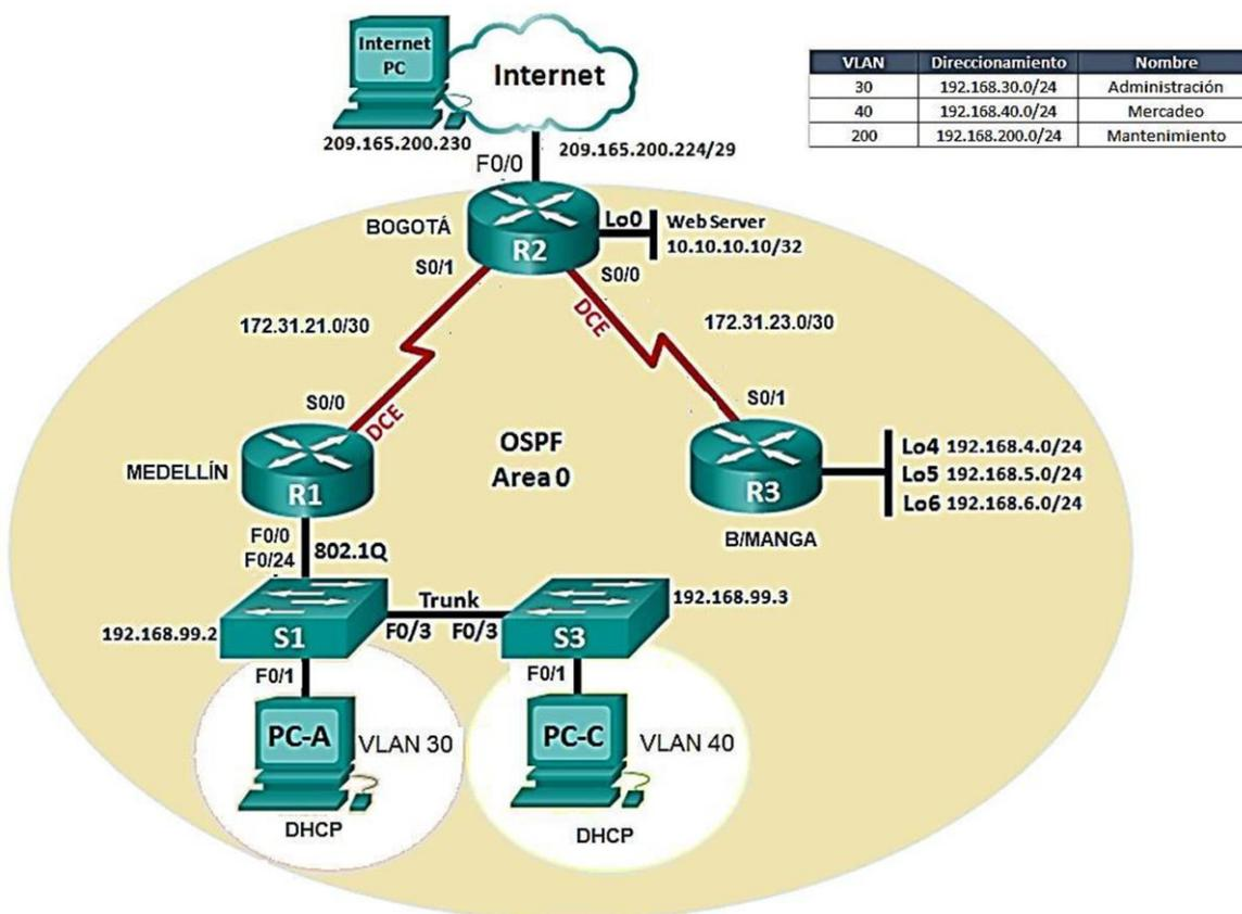
**1. Configurar el direccionamiento IP acorde con la topología de red para cada uno de los dispositivos que forman parte del escenario.**
