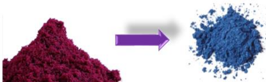
Figura 22 Sal de cloruro de cobalto hidratada y deshidratada
