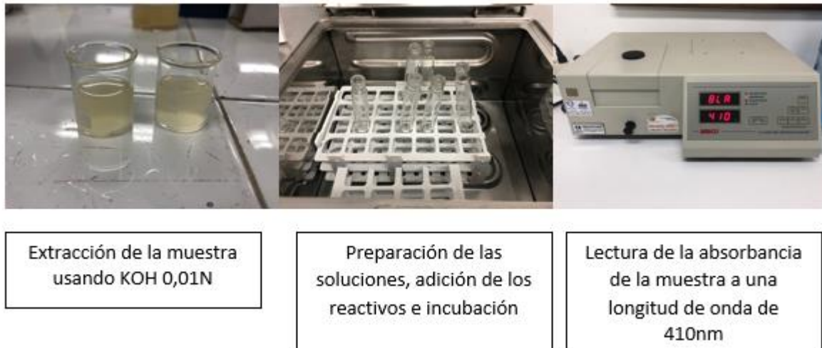
Figura 6: Ejecución del análisis de inhibidor de tripsina
