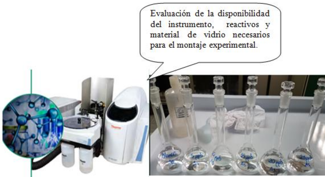
Grafico 2. Espectrofotómetro de Absorción Atómica y soluciones de Arsénico para lectura. Fuente: Autor.
