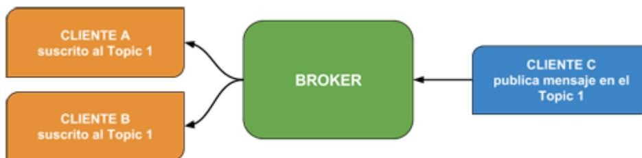
Ilustración 24 Esquema de la Arquitectura MQTT
