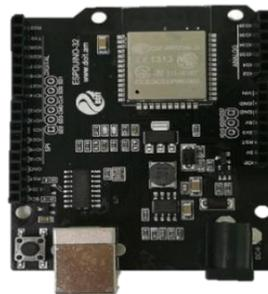
Ilustración 21: Tarjeta ESP32
