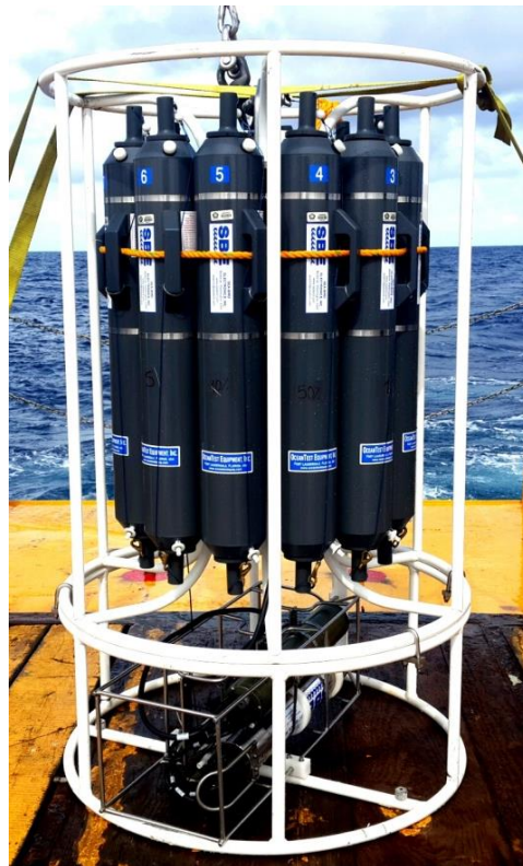
Figura 7.2. Set de botellas Niskin acopladas a roseta oceanográfica.
